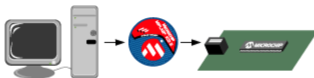
7. ábra – MPLAB ICD 2 kapcsolódási ábrája[24]
